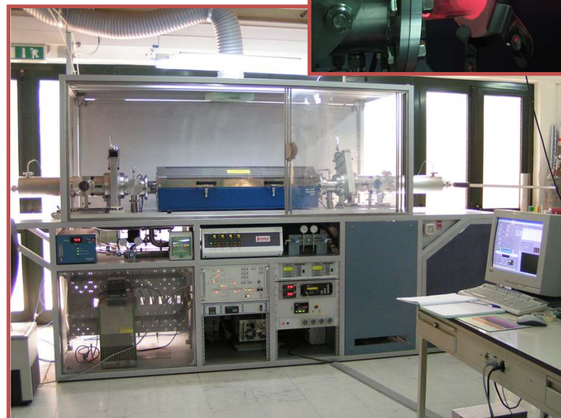
Reattore CVD per la sintesi di grafene e semiconduttori -dimensionali ('graphene-like')
