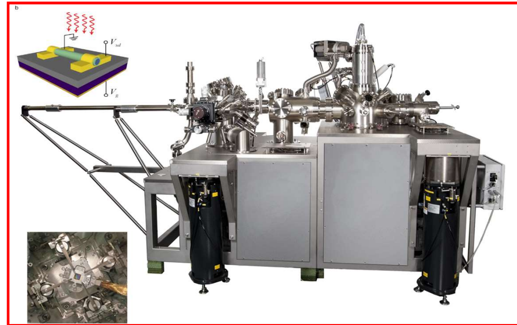
Microscopio a scansione di sonda in condizioni UHV (UHV-SPM) a 4-probe per la caratterizzazione elettrica e foto-elettrica di nano-dispositivi (Rete PHASHYN /Univ. del Salento)
